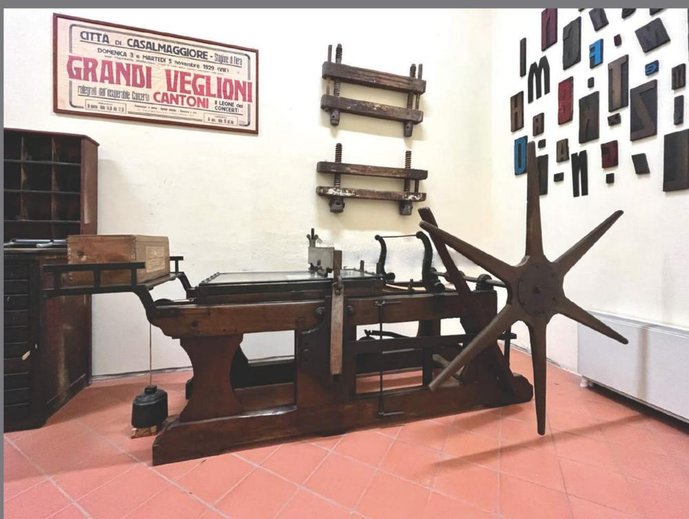
Parallelamente nell'Ottocento s'impone la tecnica di stampa in piano detta litografia: qui la matrice è costituita da una pietra calcarea (poi sostituita con più maneggevoli lastre di zinco) sulla cui superficie levigata viene tracciato il disegno con una matita litografica;
