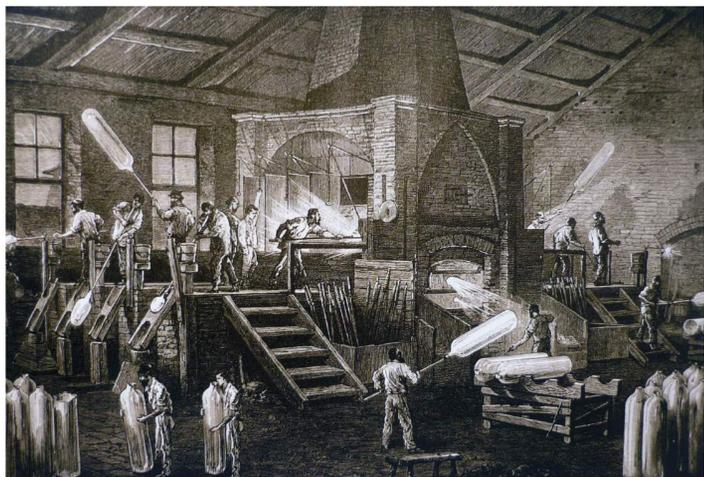
Il forno utilizzato per la fusione del vetro era a tre vani: il focolare per la combustione del legname, quello intermedio dove venivano alloggiati i crogioli con il vetro in fusione, e quello superiore nel quale venivano sistemati gli oggetti finiti per essere ricotti e raffreddati gradualmente.
